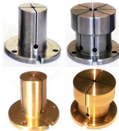
H – 50 mm, profondeur Maxi d'usinage conseillée => serrage ouvrant et fermant : 8 mm.
